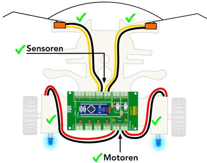
Beste Leitungsführung: Sensoranschlüsse in Fahrtrichtung und kurze, direkte Verbindungen
