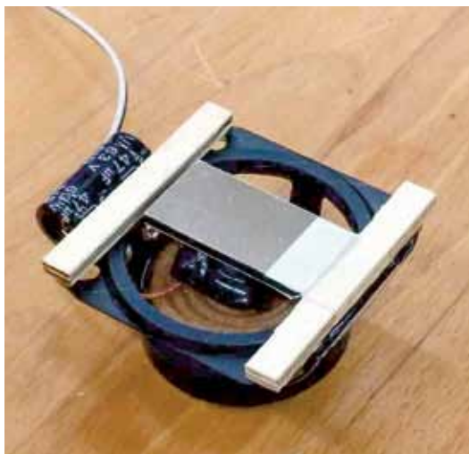
Aus dem Lautsprecher wird ein programmierbares Spiegelmodul.
